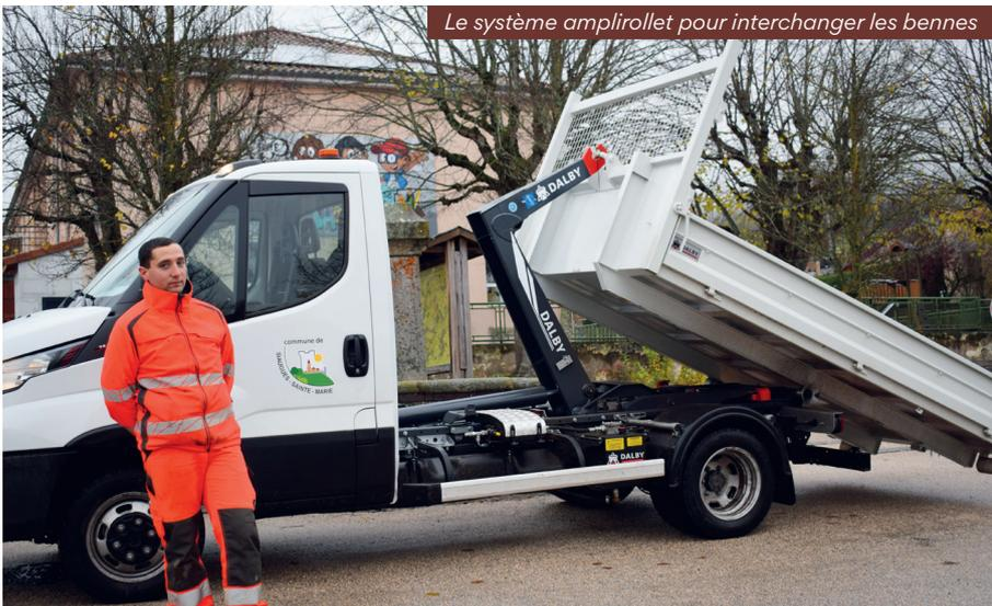
Le système amplirollet pour interchanger les bennes
